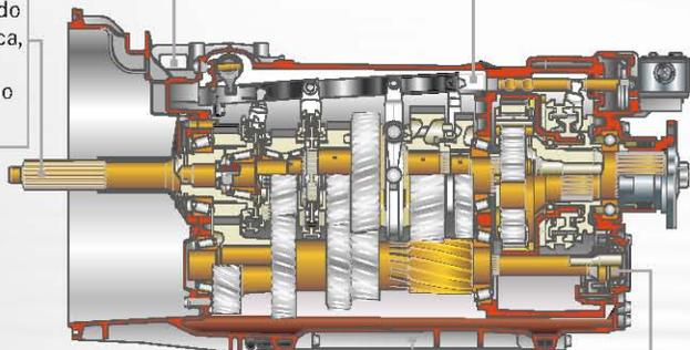
**Carcasas/Eixo Piloto/Eixo Principal/Eixo Intermediário/Engrenagens** e demais peças, após a aprovação visual, são submetidas a rigorosos testes para identificar trincas e imperfeições. Caso necessário, há substituição por peças genuínas novas.
