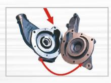
Irregularidades nas medidas das tampas e nas coordenadas dos furos de fixação ao bloco.
