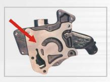
Rugosidade na face de encosto da bomba ao bloco fora do padrão Mercedes-Benz.
